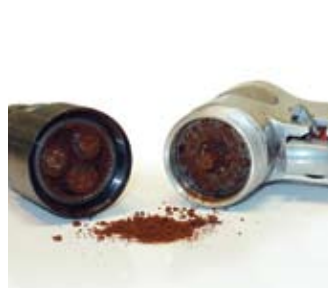
Вышедшая из строя пневматическая арматура
